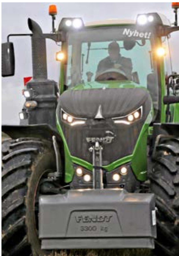
Fendt 1050 är världens största konventionella traktor med 517 hästkrafter och 14 ton. FOTO: FREDRIK THUNBERG
