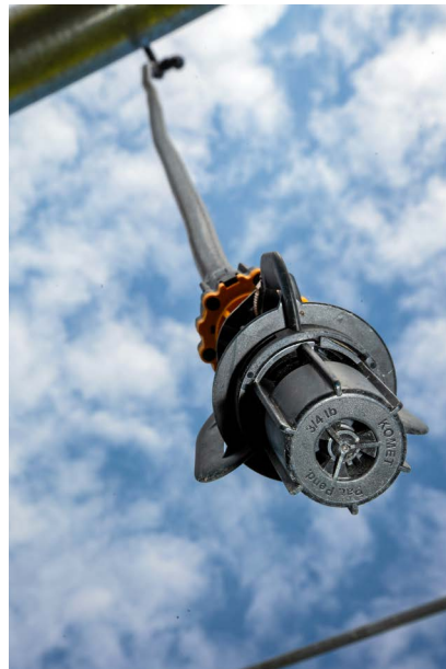
Ett VRI-system, möjliggör bevattning med varierad giva. Varje enskilt munstycke styrs av VRI-systemet.
