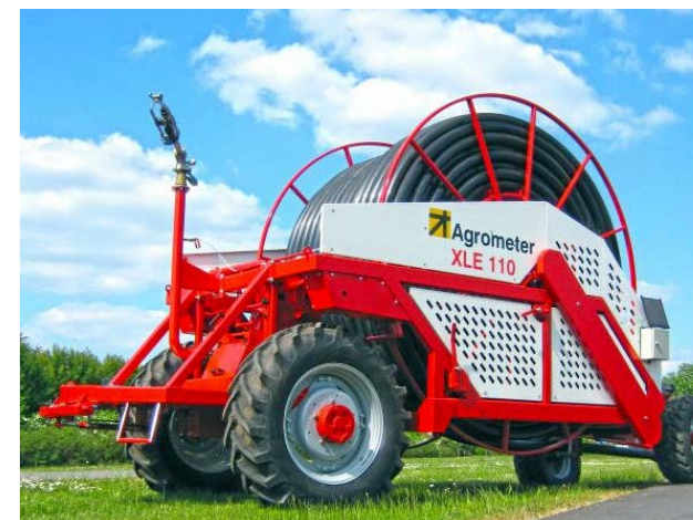
Det finns även ett tredje alternativ. Den här varianten från Agrometer bygger på att slangen rullas ut och sedan följer maskinen slangen på tillbakavägen, enligt principen att vagnen svänger där slangen gör det.
