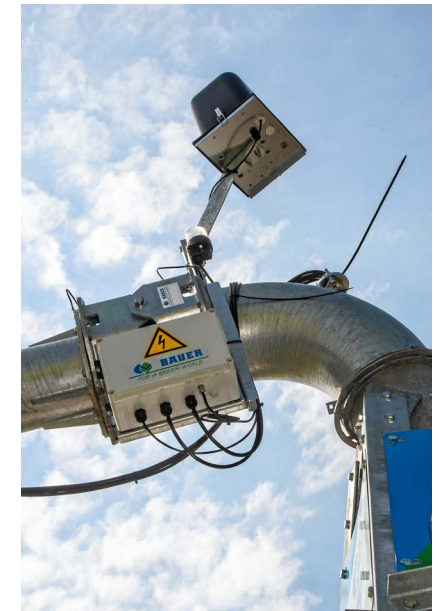
GPS-mottagaren och styrutrustningen på anläggningen reglerar magnetventilerna.
