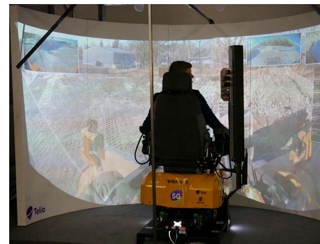
Föraren styr från ett litet förarsäte uppkopplad framför en stor projektor som visar sikten fram, bak och åt sidorna.
