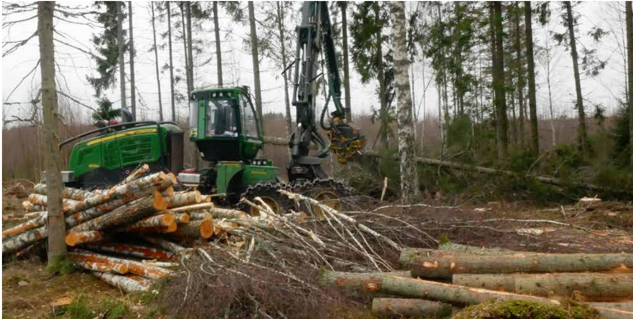
Varje enskild stock fotograferas via kamera i skördaraggregatet och ett digitalt "fingeravtryck" skapas som följer med i hela produktionskedjan.
