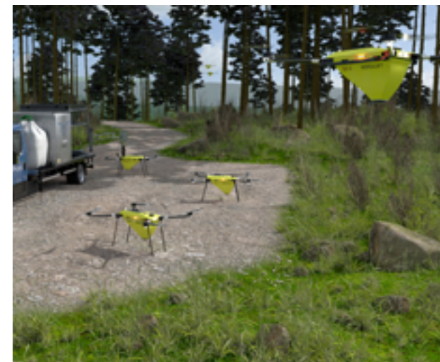
Prototypen har en bredd på omkring 2 meter och kan bära 30-50 kilo material.
