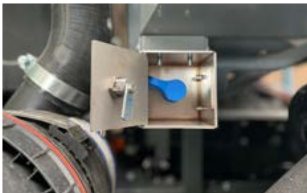
Påfyllningen av vätgasen hittar vi bakom en låsbar lucka.
