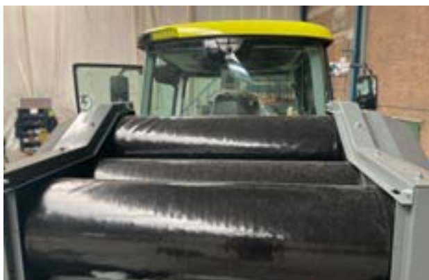
Varje vätgastank bakom hytten väger 110 kilo när den är tom. När den är fulltankad med vätgas väger den bara 5 kilo mer.
