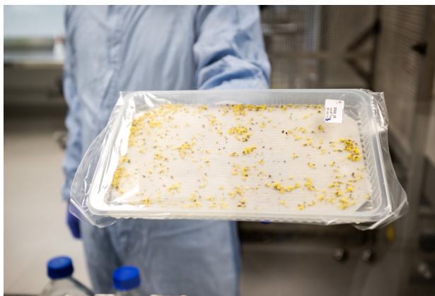
På brickor stimuleras cellerna att bilda små embryon. Dessa planteras sedan av en robot i plantbrätten för att växa till sig.
