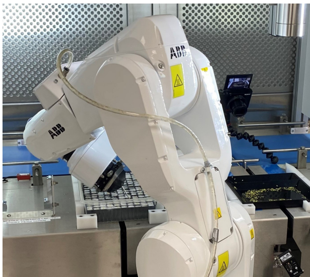
Det är en industrirobot från ABB som plockar upp embryon och planterar dem i plantbrätten.
