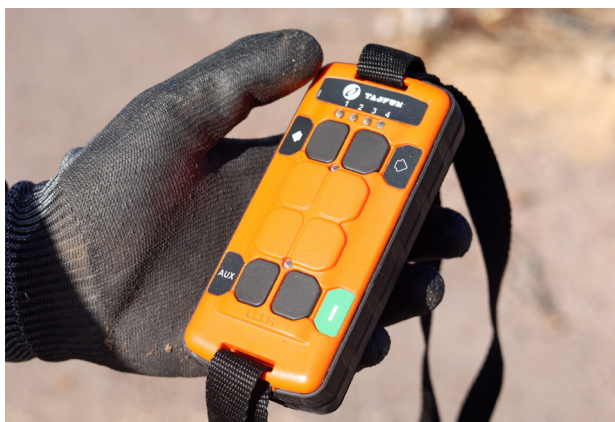
Stockbordet manövreras med en fjärrkontroll vilket ger en frihet från vedmaskinen.
