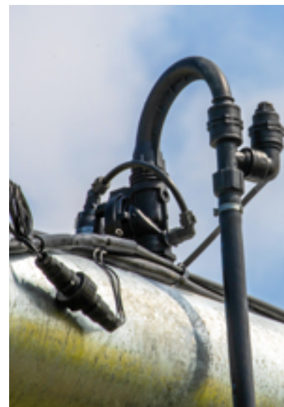
Munstyckena öppnas och stängs med hjälp av magnetventiler.
