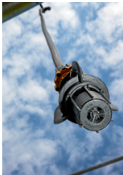
Ett VRI-system, möjliggör bevattning med varierad giva. Varje enskilt munstycke styrs av VRI-systemet.
